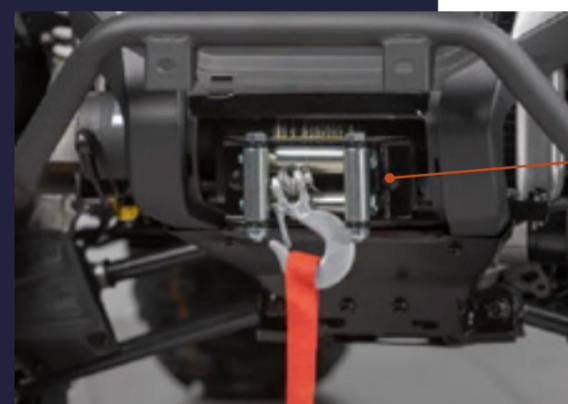
Guincho elétrico para 3000 lbs com controle remoto e acionamento no guidão
