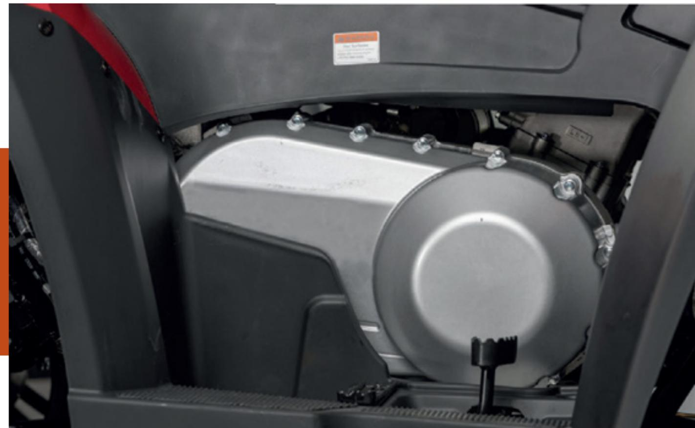
Seu motor monocilíndrico, SOHC, 383 cc, com refrigeração líquida, aliado ao sistema de injeção eletrônica de última geração DELPHI, garante um baixo consumo de combustível e resposta rápida aos comandos do acelerador.
