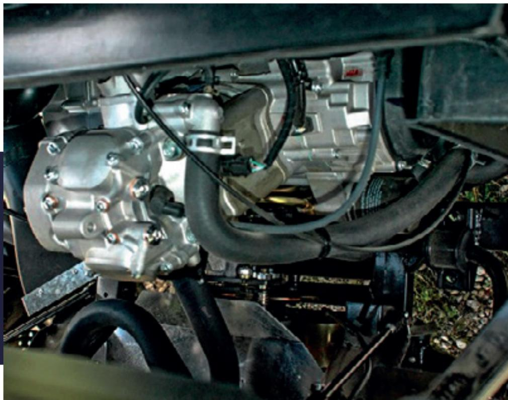
Seu motor monocilíndrico, SOHC, 500 cc, com refrigeração líquida, aliado ao sistema de injeção eletrônica de última geração DELPHI, garante um baixo consumo de combustível e resposta rápida aos comandos do acelerador.
